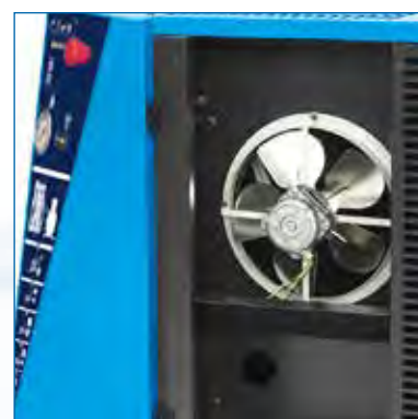
Refroidissement par un ventilateur électrique supplémentaire (sur les modèles 7,5 et 10 ch)
